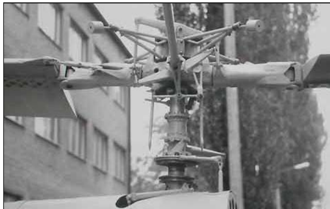
Głowica wirnika z eliminatorem drgań
