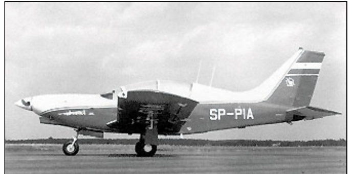
Pierwszy prototyp SP-PIA z silnikiem PZL-Franklin 220 KM (pierwszy lot 1986)
