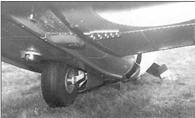
Po złożeniu przedniego podwozia. Pod kadłubem widoczne omegówki zabezpieczające koła
